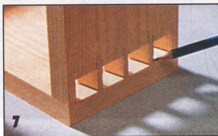
7 Обвод готовых шипов даёт линию разметки «ласточкиных хвостов» на сопрягаемых деталях.
